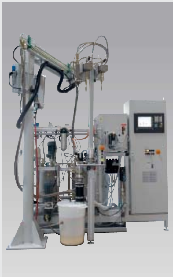
C-DS avec tête de mélange manuelle sur balancier
