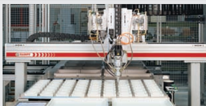
Förderband mit Wechselträgern (Paletten)
