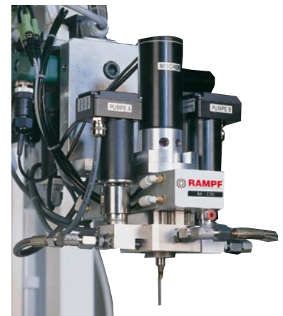
Bild 2: Beim Minimalmengen- Dosiersystem sind die Zahn- radpumpen direkt am Mischsystem angebaut. Das Fördervolumen der Pumpen liegt bei 50 \text{ mm}^3 / \text{Umdrehung} .
