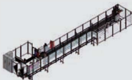
» 5 DR-CNC mit Pufferbandanlage und parallel ablaufender Plasmaaktivierung
