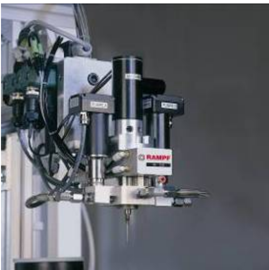
Abb.2: Beim Minimalmengen-Dosiersystem sind die Zahnradpumpen direkt am Mischsystem angebaut. Das Fördervolumen der Pumpen liegt bei 50 mm 3 /Umdrehung.
