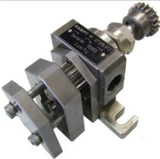
Abb.1: Zahnradpumpen zählen zu den präzisesten Dosierpumpen.
